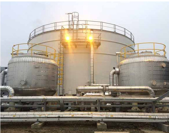
PP zavodu/ MŞ və ÜT: Homogenləşdirmə qurğusu / Qarışdırıcı silolar. Buraxılış-sazlama işləri davam etmişdir
